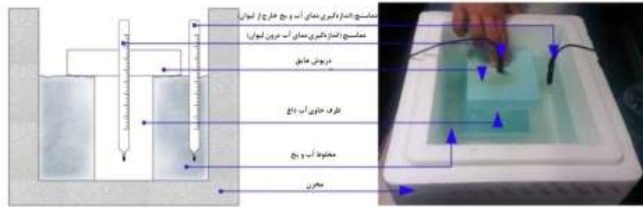
شکل ۱. پیکربندی آزمایش اندازه گیری ضریب رسانش گرمایی. شماتیک (سمت چپ) و واقعی (سمت راست). (ژیوب و چیپک، ۲۰۲۰)
