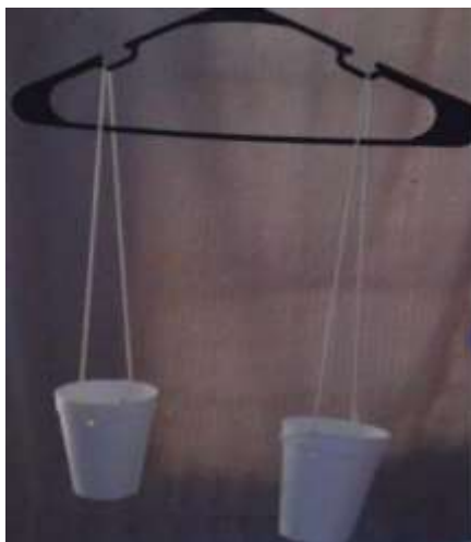
شکل ۱. استفاده از وسایل موجود در خانه برای ساخت ترازو (سلکو، ۲۰۲۰).
