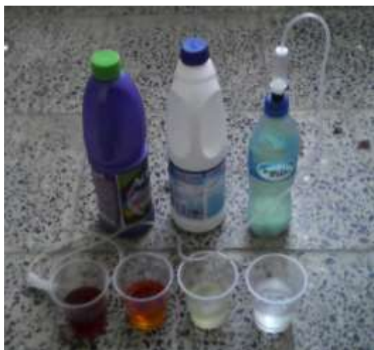
شکل ۴: واکنش گاز کلر تهیه شده با محلول‌های بتادینی که از قبل به آن آب پرتقال اضافه شده بود و پتاسیم‌یدید از این آزمایش می‌توان در آموزش شیمی پایه یازدهم استفاده کرد.
