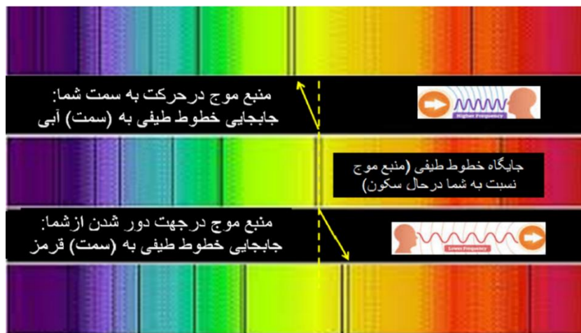
شکل ۳. انتقال خطوط طیفی منتشرشده از جو یک ستاره، زمانی که به ناظر زمینی نزدیک یا دور می‌شود (نوار طیفی بالایی و پایینی تصویر). نوار طیفی میانی، خطوط طیفی را زمانی که منبع و ناظر نسبت به هم حرکتی ندارند را نشان می‌دهد (مثلاً در یک آزمایشگاه زمینی).
